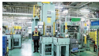
インライン生産を可能にした1ストロークプレス 1 stroke press, enabling in-line production
